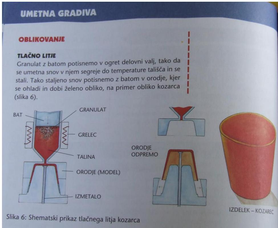
Slika 6: Shematski prikaz tlačnega litja kozarca
